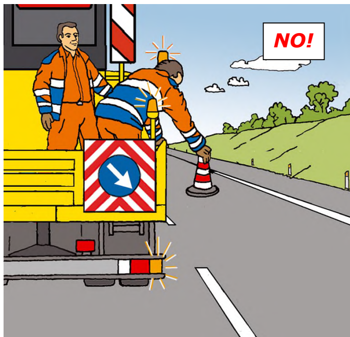
Figura 60 – Posizionamento dei coni o defleco: comportamento scorretto
